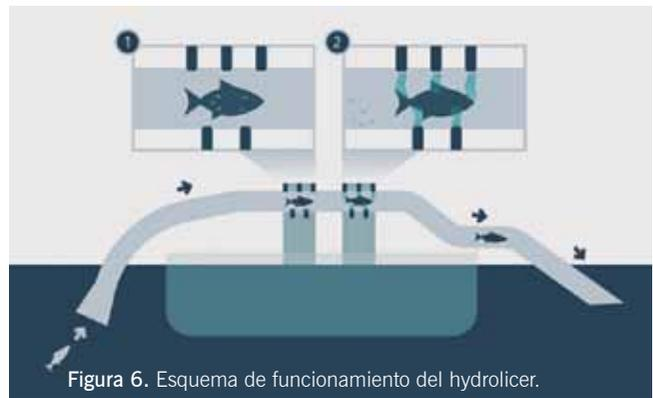
Figura 6. Esquema de funcionamiento del hydrolicer.
