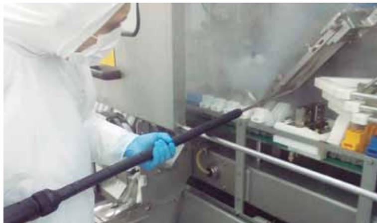
*Una solución de higiene especializada mediante la aplicación de vapor en áreas de manipulación de alimentos.*
